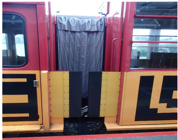
【転落防止ホロー設置】
